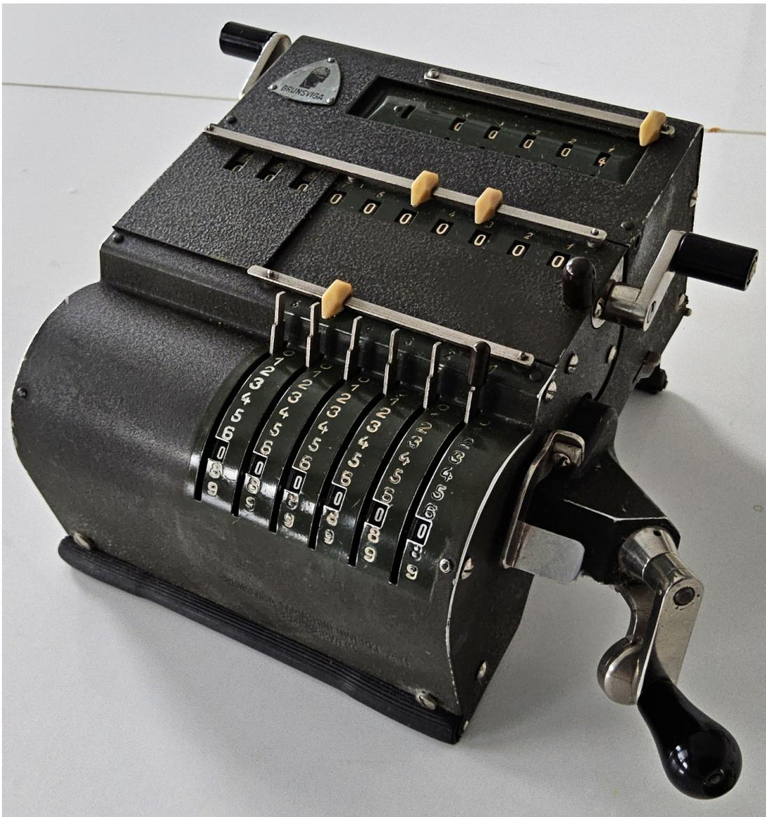
Brunsviga nutzte bis zum Tode des Firmenchefs Franz Trinks 1931 ausschließlich das Sprossenrad-System als Funktionsprinzip seiner Maschinen.
