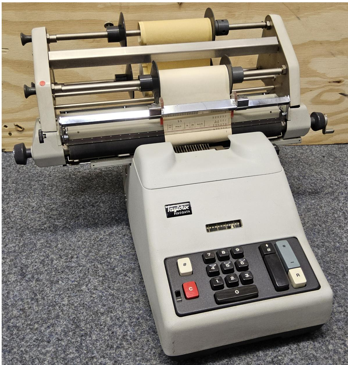
Die Taylorix Fixodata ist eine elektromechanische Zweispezies Buchungsmaschine mit Springwagen. Die Walzenbreite beträgt 340mm. Sie arbeitet nach dem Zahnstangenprinzip. Druck: Maschinenlesbare OCR-Schrift für die Datenerfassung,
