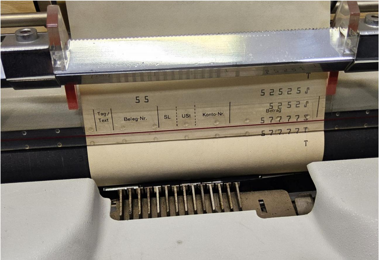
Es ist auch ein Anschluss für einen Streifenlocher verfügbar mit dem numerische Daten erfaßt werden können. Bei abgeschaltetem Streifenlocher kann mit verschiedenen Programmen konventionell gebucht werden. Die technische Basis bildet eine Odhner-Saldiermaschine Model: 1422
