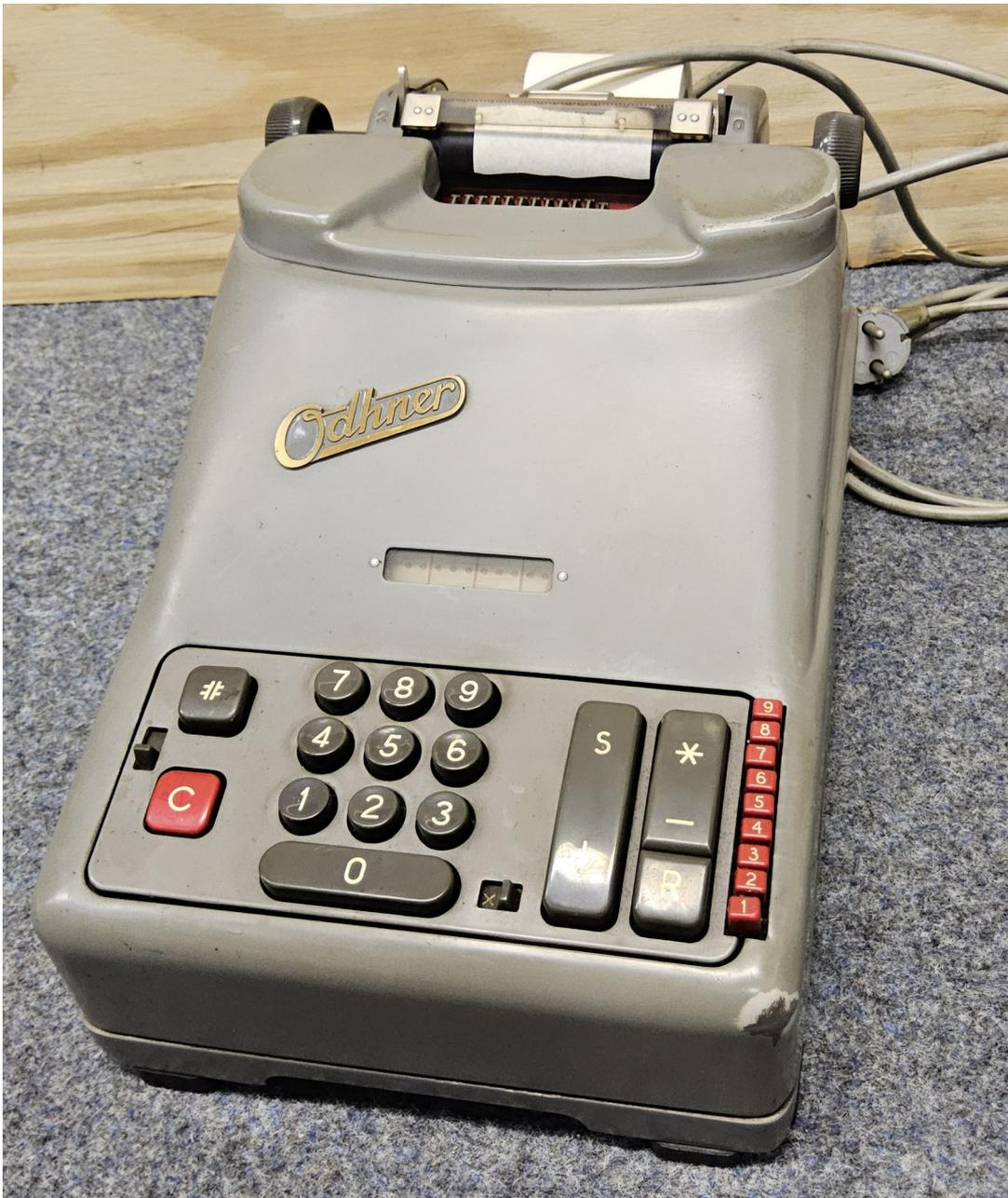
Die XX-11-C-7 ist eine druckende, elektromechanische Zahnstangenrechenmaschine mit Zehnertastatur und Stiftschlitten.
