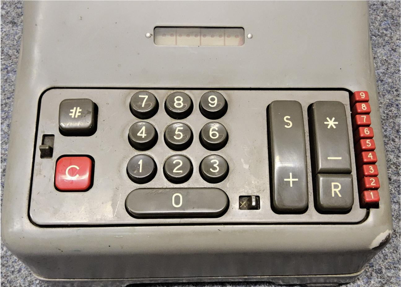
Nach Ablauf der letzten Rechenstelle wird der Multiplikand mit der „C“-Taste gelöscht und das Produkt mit der Schlußsummentaste gedruckt.
