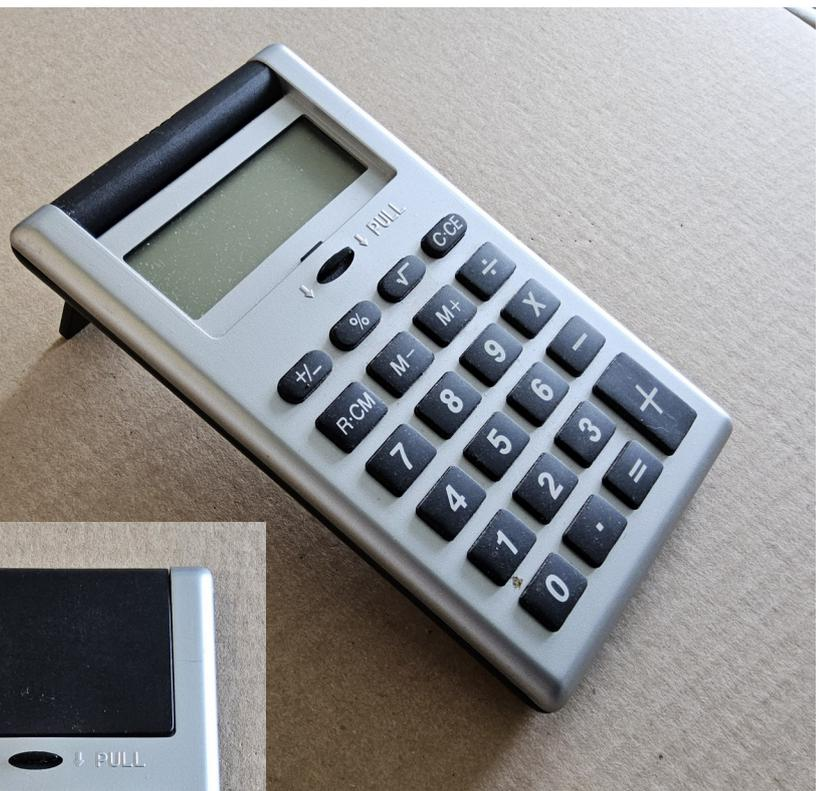
Dieser einfache Taschenrechner mit den gängigsten Rechenarten und Speicher ausgestattet. Im Kunststoffgehäuse mit Schutzklappe für das LCD-Display. Aufgeklappt dient es als Ständer für das Arbeiten auf dem Tisch. Die Batterie ist im verschraubtem Gehäuse eingebaut. Werbeartikel. Taschenrechner werden unter diesem Label noch heute produziert.
