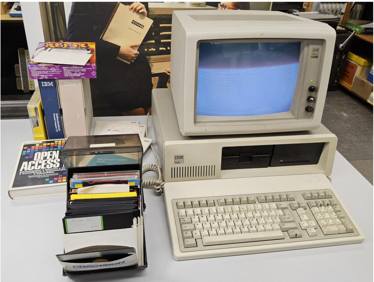
Das hier vorgestellte Objekt ist ein IBM PC, Model 5150 mit Farbgrafikkarte, Speichererweiterung, Farbmonitor und umfangreicher Dokumentation und Software.
