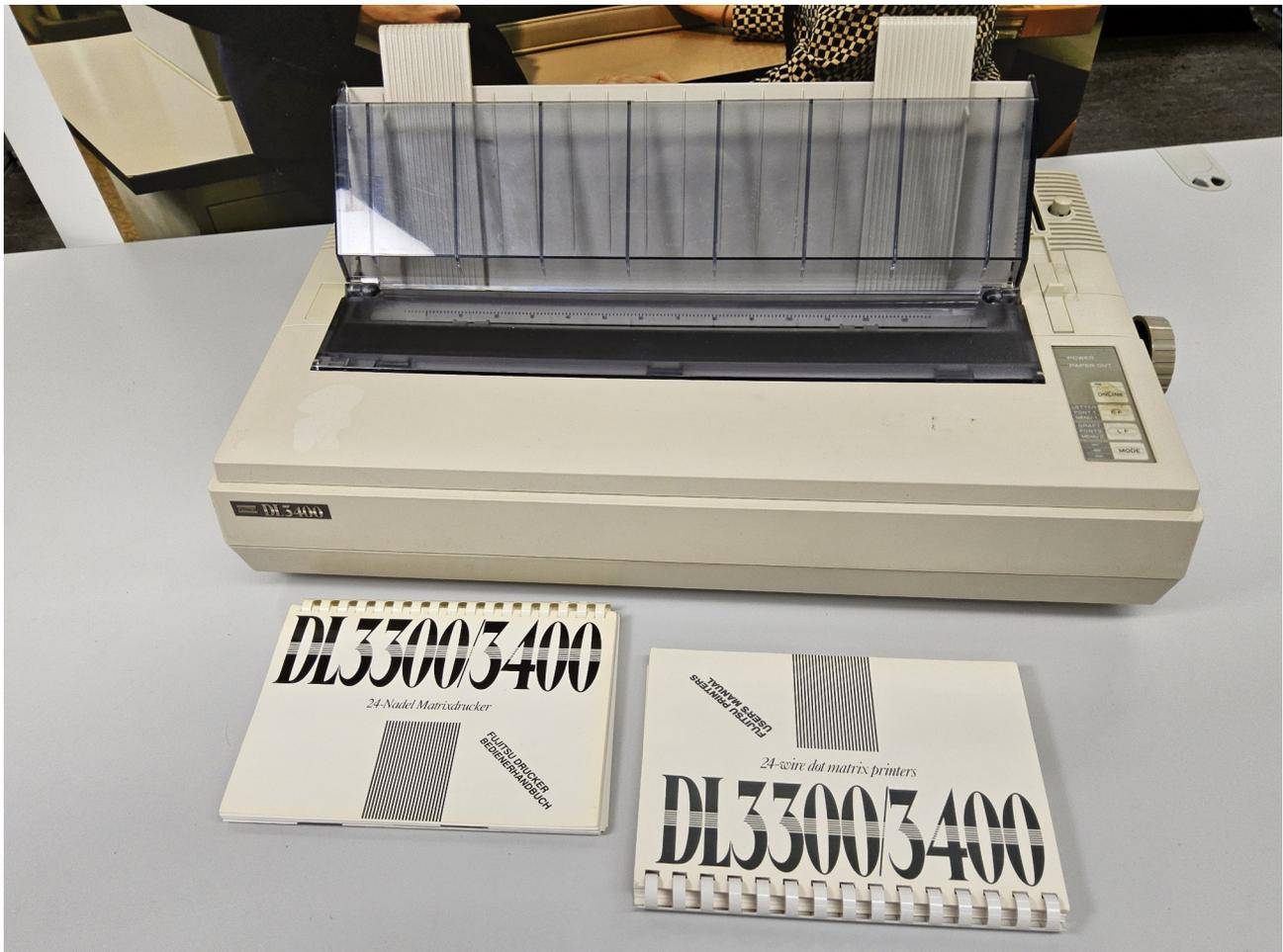
Der DL3400 besitzt einen 24 Nadel-Druckkopf, der maximal 360 x 180 Punkte pro Quadratzoll (2,54 x 2,54 cm) druckt, bei einer Geschwindigkeit von 240 Zeichen pro Sekunde.
