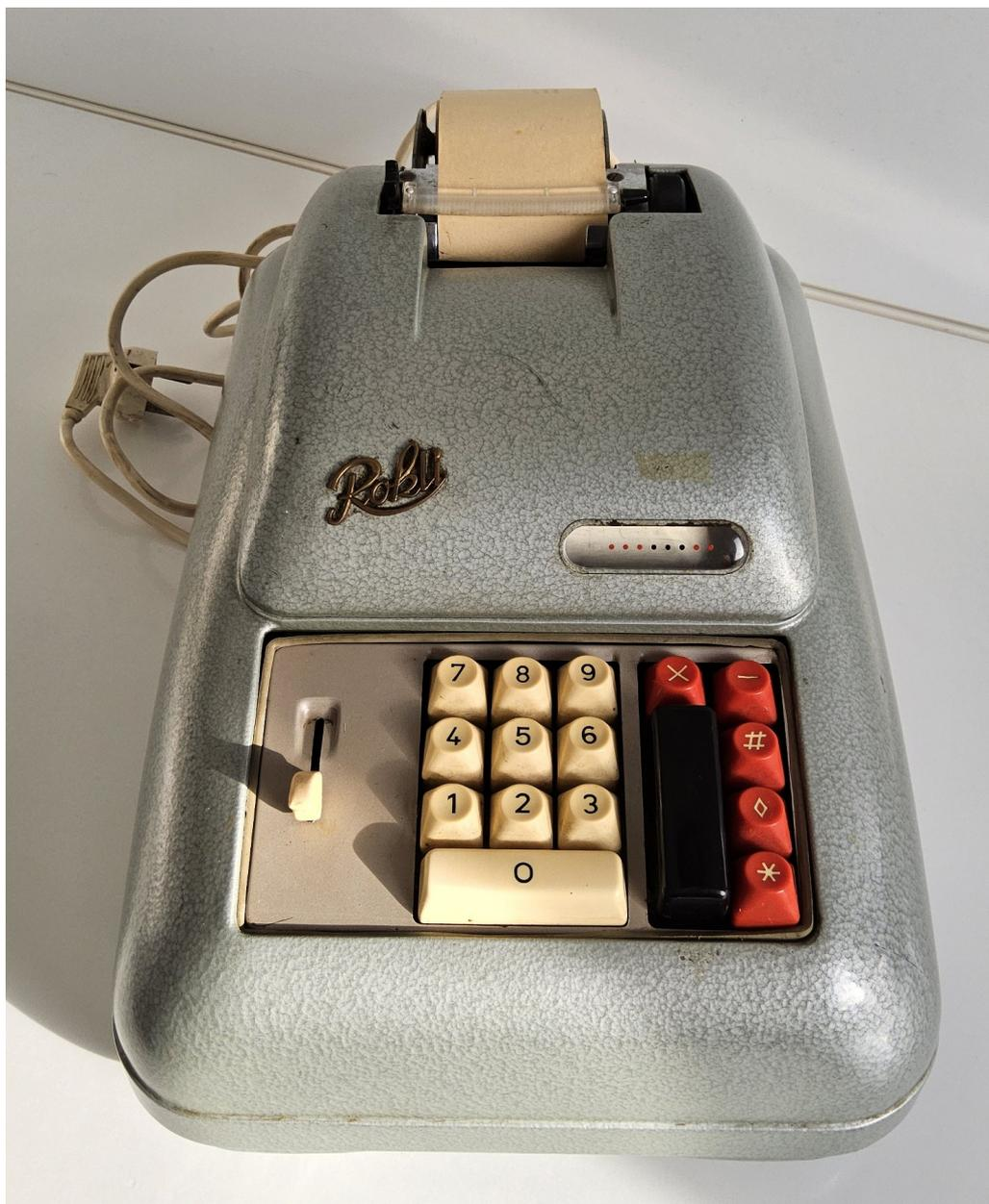
Die Rokli A 17 E ist eine elektromechanische, druckende Zweispezies-Addiersegmentmaschine mit Zehnertastatur.
