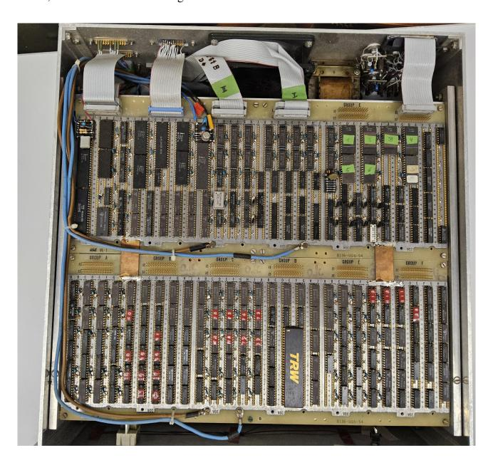
Der hier vorgestellte NSP 81 zeigt mit verhältnismäßig geringen Aufwand, mit ca. 210 Elektronikbausteinen, die Realisierung eines flexiblen, schnellen Signalprozessors, der die zuvor erwähnten Nachteile weitgehend vermeidet.
