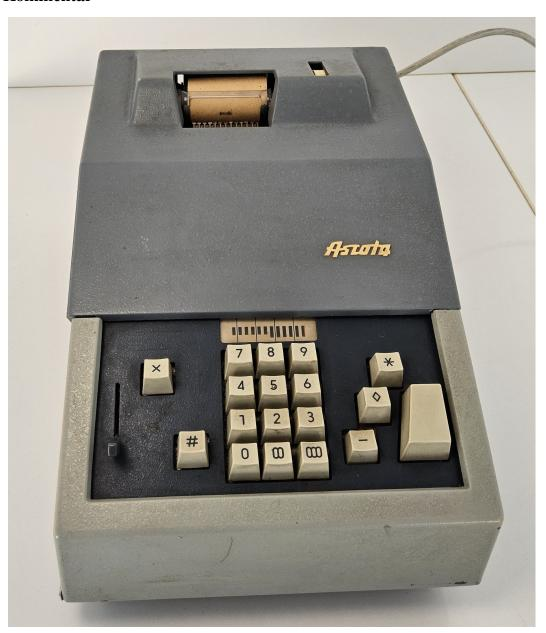
Die Rechenmaschine Ascota 114 ist eine Zahnstangen-Simplexmaschine mit Druckwerk und Zehnertastatur.
