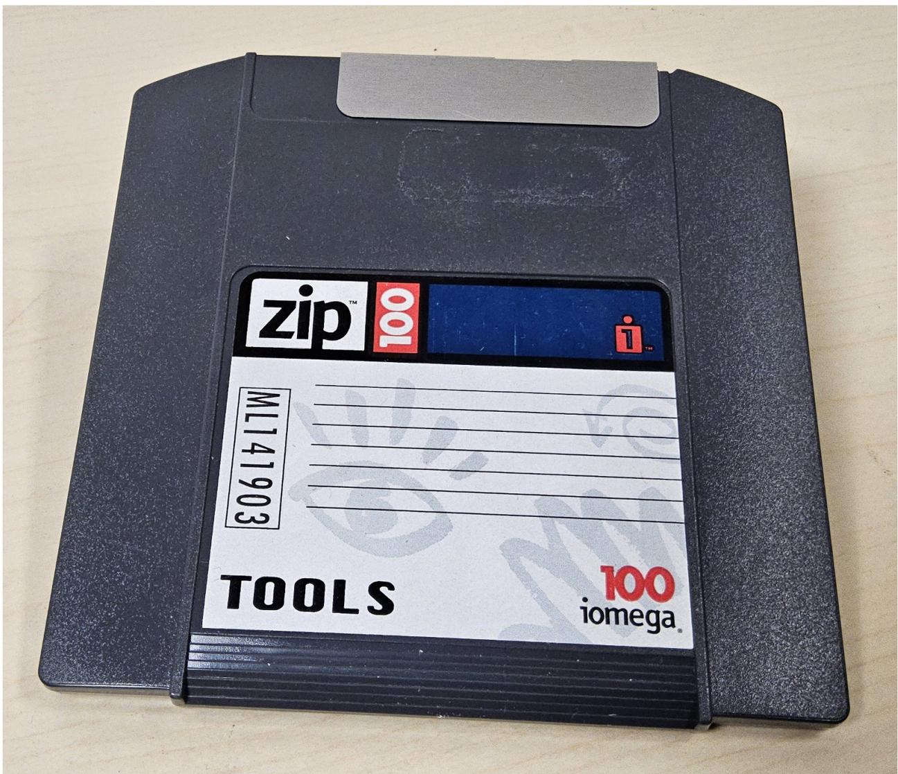
Es gab sie mit einer Speicherkapazität von 100 MB, 250 MB und 750 MB, als Externes Laufwerk oder für den Einbau in einen 3,5“ Slot. Vor Allem die erste Generation, Mitte der 90er Jahre, mit 100 MB Speicherkapazität war sehr beliebt, da sie mit ihrem Speichervolumen die aktuellen Techniken wie die Disketten bei Weitem übertrafen.
