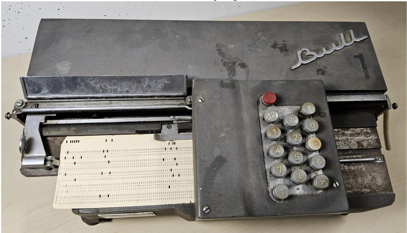
Die Tastatur des Typs 011 hat 12 Tasten, eine für jede der 12 Reihen der Karte, sowie eine Freigabetaste und eine Leertaste. Mit jedem Tastendruck wird ein Loch in die entsprechende Zeile gestanzt und die Karte um eine Spalte weitergeschoben. Mit der Taste X wird zum nächsten Tabstopp (falls vorhanden) gesprungen.
