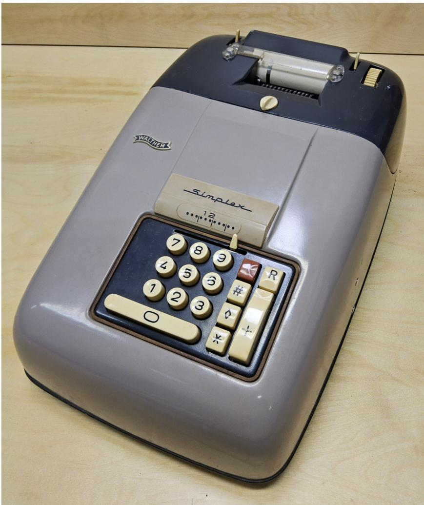
Die Walther Simplex S12 ist eine einfache saldierende und druckende elektromechanische Addiermaschine im Zahnstangenprinzip. Die Eingabe erfolgt über eine Zehnertastatur.
