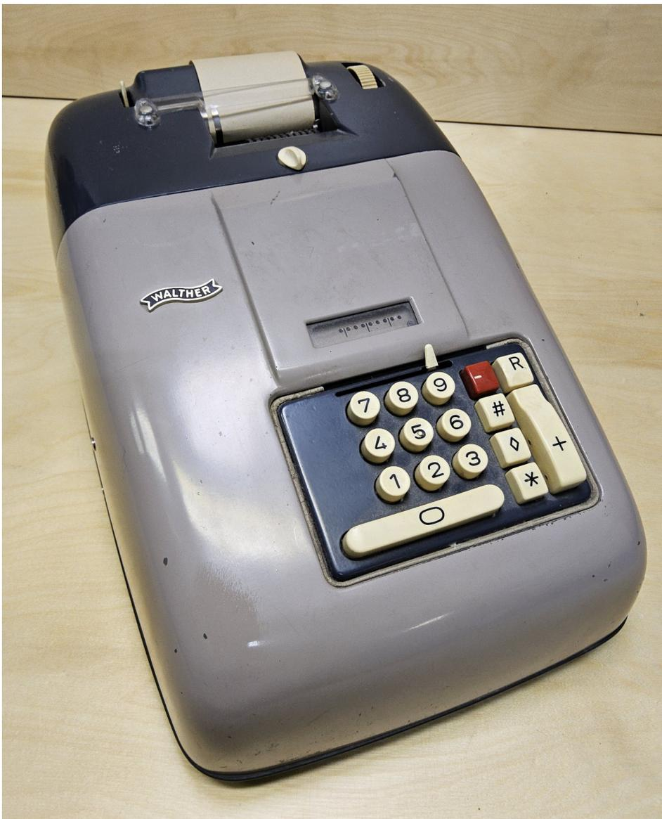
Die Walther S10 ist eine elektromechanische, druckende Zweispezies-Zahnstangen Addiermaschine mit Stiftschlitten.
