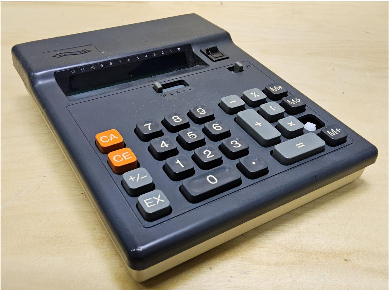
Der ETR 1081 ist ein elektronischer Tischrechner der Firma Walther. Tischrechner mit Digitronanzeige für 220V- oder 110V-Betrieb mit zwölf Stellen, Prozentautomatik, Wechseltaste, Gleit- und Festkomma und saldierendem Speicher. Die integrierten Schaltkreise stammen von Rockwell.
