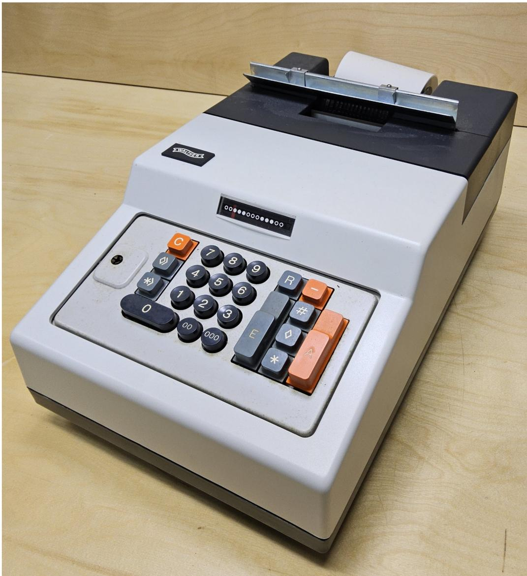
Die Walther Duplex 32 ist ein druckender elektromechanischer Tischrechner, mit zwei Saldierwerken. Das Modell Simplex hingegen besitzt nur ein Rechenwerk.
