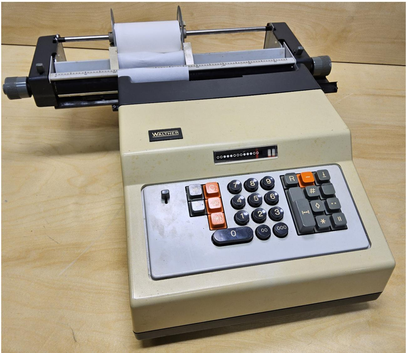
Die Walther Duplex 232 ist ein elektromechanischer Tischrechner, druckend mit Schüttelwagen. Funktionsprinzip: Zahnstange, mit Zehnertastatur
