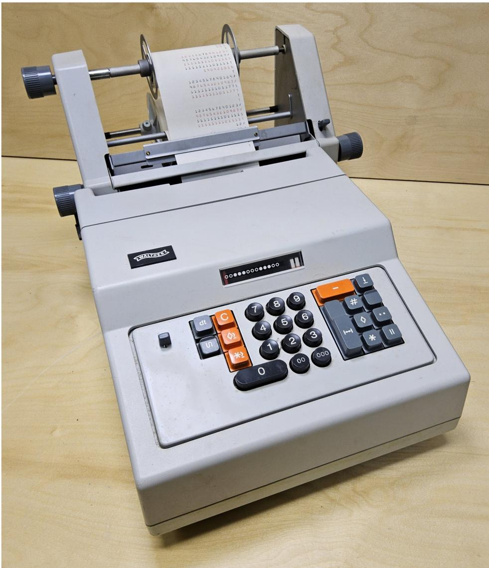
Die Walther Duplex 224 ist ein elektromechanischer Tischrechner, druckend mit Schüttelwagen. Funktionsprinzip: Zahnstange, mit Zehnertastatur
