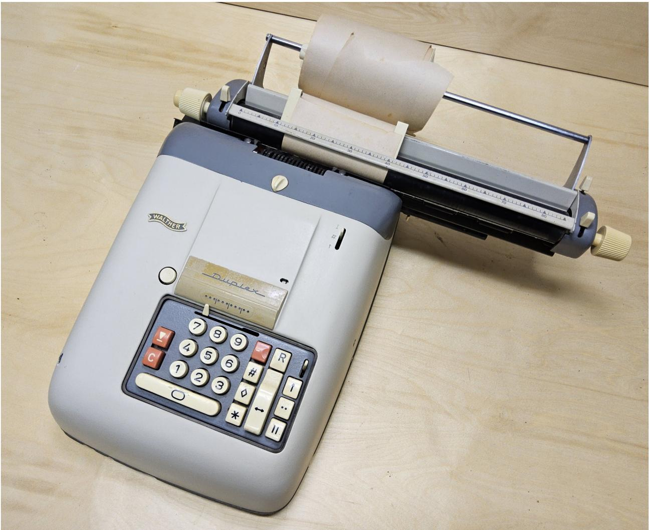
Die Walther Duplex DS232 ist ein elektromechanischer Tischrechner, druckend mit Schüttelwagen. Funktionsprinzip: Zahnstange, mit Zehnertastatur
