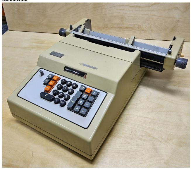
Die Walther DS232 ist ein elektromechanischer Tischrechner, druckend mit Schüttelwagen. Funktionsprinzip: Zahnstange, mit Zehnertastatur
