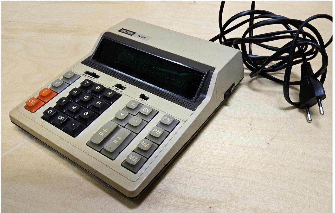
Der Walther 3005 ist ein elektronischer Tischrechner mit Anzeige. Tischrechner mit 12-stelliger Digitronanzeige, 5/4-Rundung, Konstantenautomatik, Korrekturtaste, Prozentautomatik, Quadratwurzeltaste, Gleit- und Festkomma und saldierendem Speicher.
