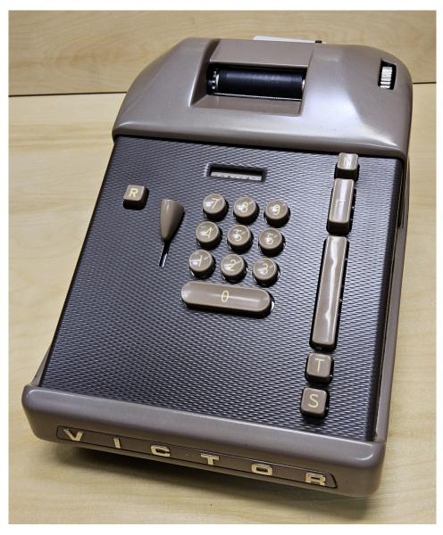
Die Victor 17-83-54 ist eine elektromechanische, druckende Zweispezies-Zahnstangenmaschine mit Zehnertastatur und Stiftschlitten.
