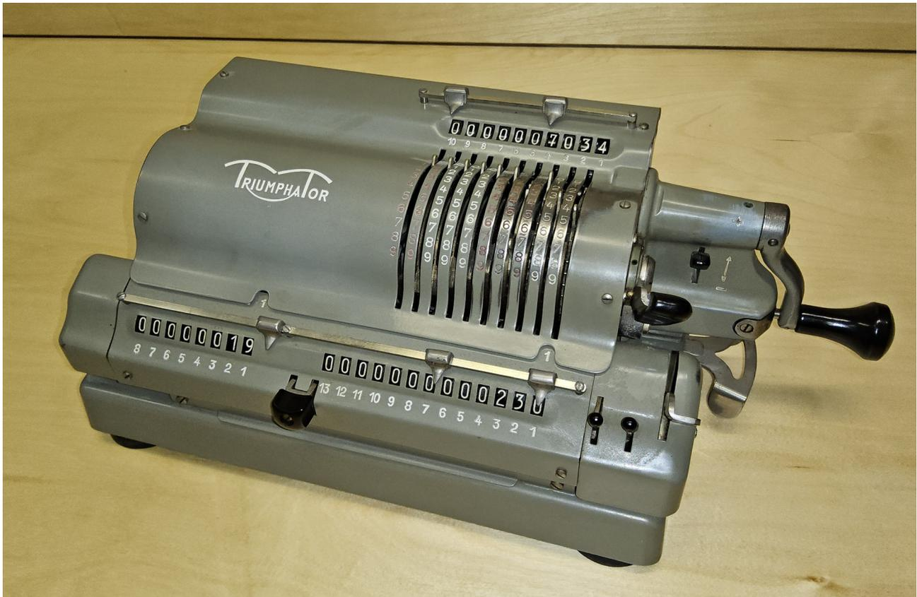
Die Triumphator ist eine 4-spezies Sprossenradmaschine.
