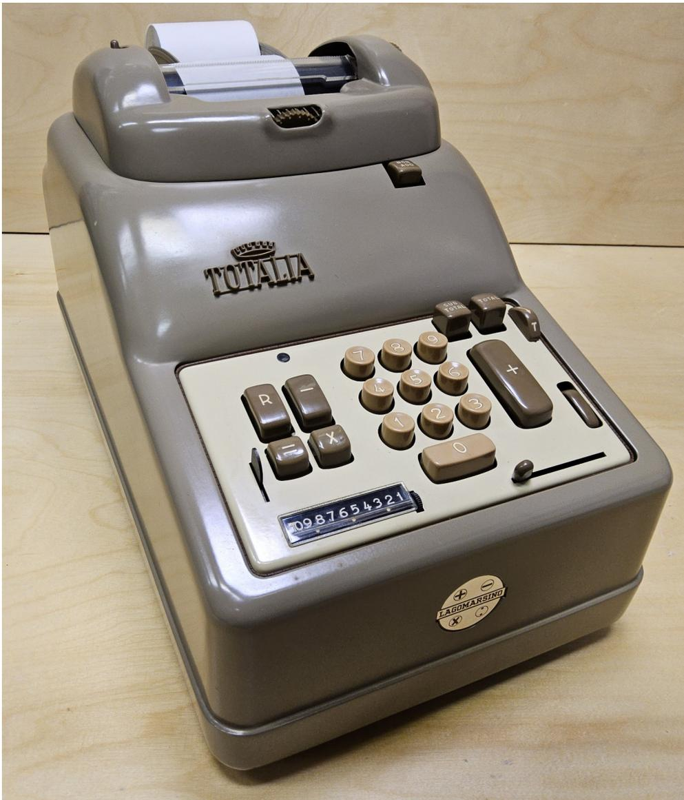
Die Totalia ist eine elektromechanische, druckende 3-spezies Zahnstangenaddiermaschine. Sie ist saldierend. Eingabe über Zehnertastatur.
