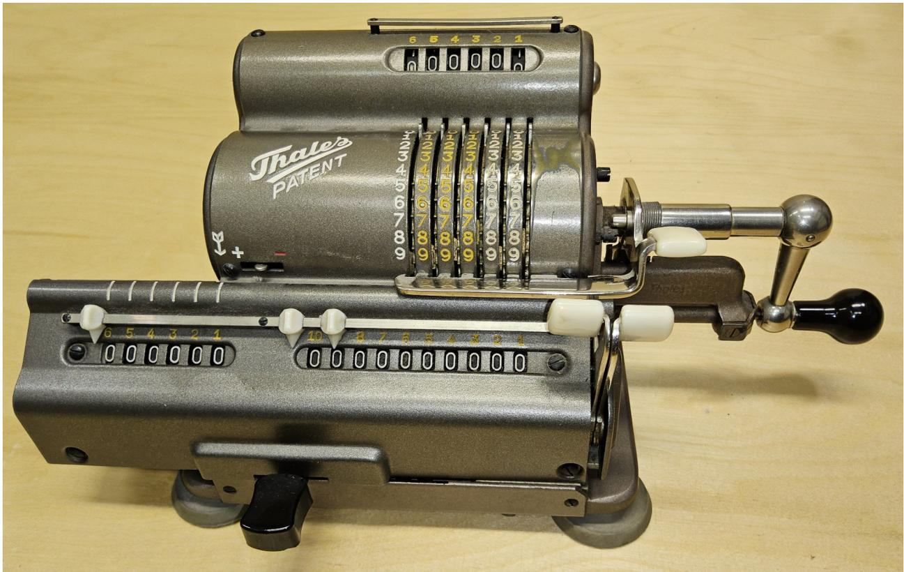
Die Thales ME ist eine 4-spezies Sprossenradmaschine.
