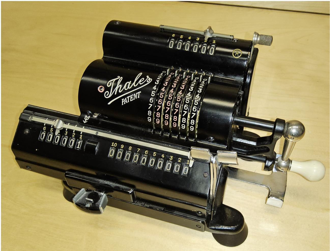
Die Thales ME ist eine 4-spezies Sprossenradmaschine.
