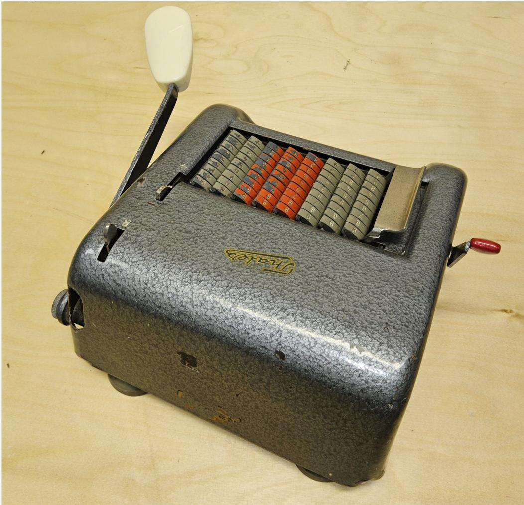
Die Tastaturlöschung erfolgt durch den breiten Hebel links der Tastatur.
