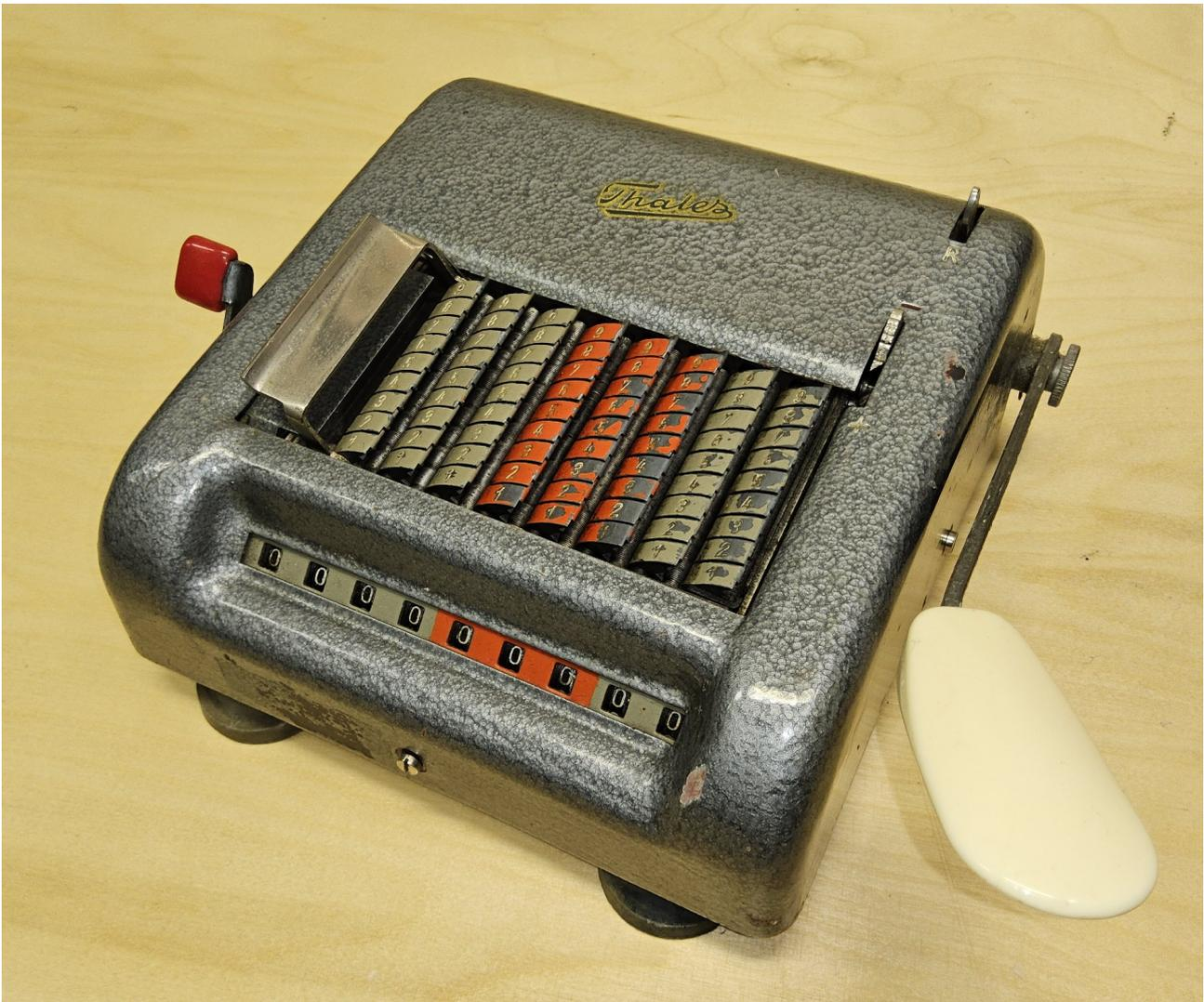
Die Thales KA ist eine Kleinaddiermaschine. Die Eingabe funktioniert über eine Volltastatur mit Kipphebeln.
