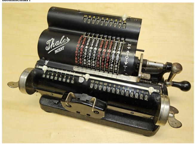
Die Thales CE ist eine 4-spezies Sprossenradmaschine.
