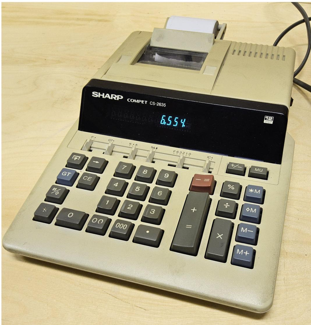
Der Sharp Compet CS-2635 ist ein elektronischer, druckender Tischrechner mit Anzeige. Die Anzeige ist 12+1 stellig.
