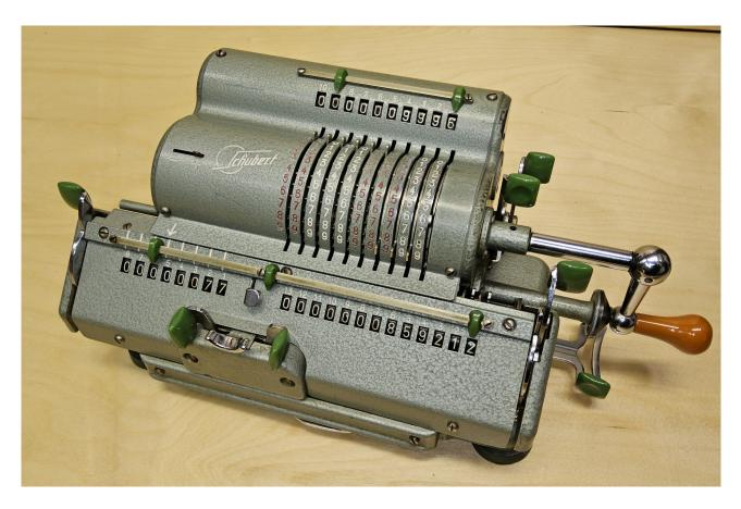
Die Schubert DRV ist eine Vierspezies-Sprossenradmaschine. Das Sprossenrad ist ein Zahnrad, dessen Zähne durch Ein- und Ausfahren zwischen null und neun Zähnen variiert werden können. Erfunden 1709 von Poleni in Padua.
