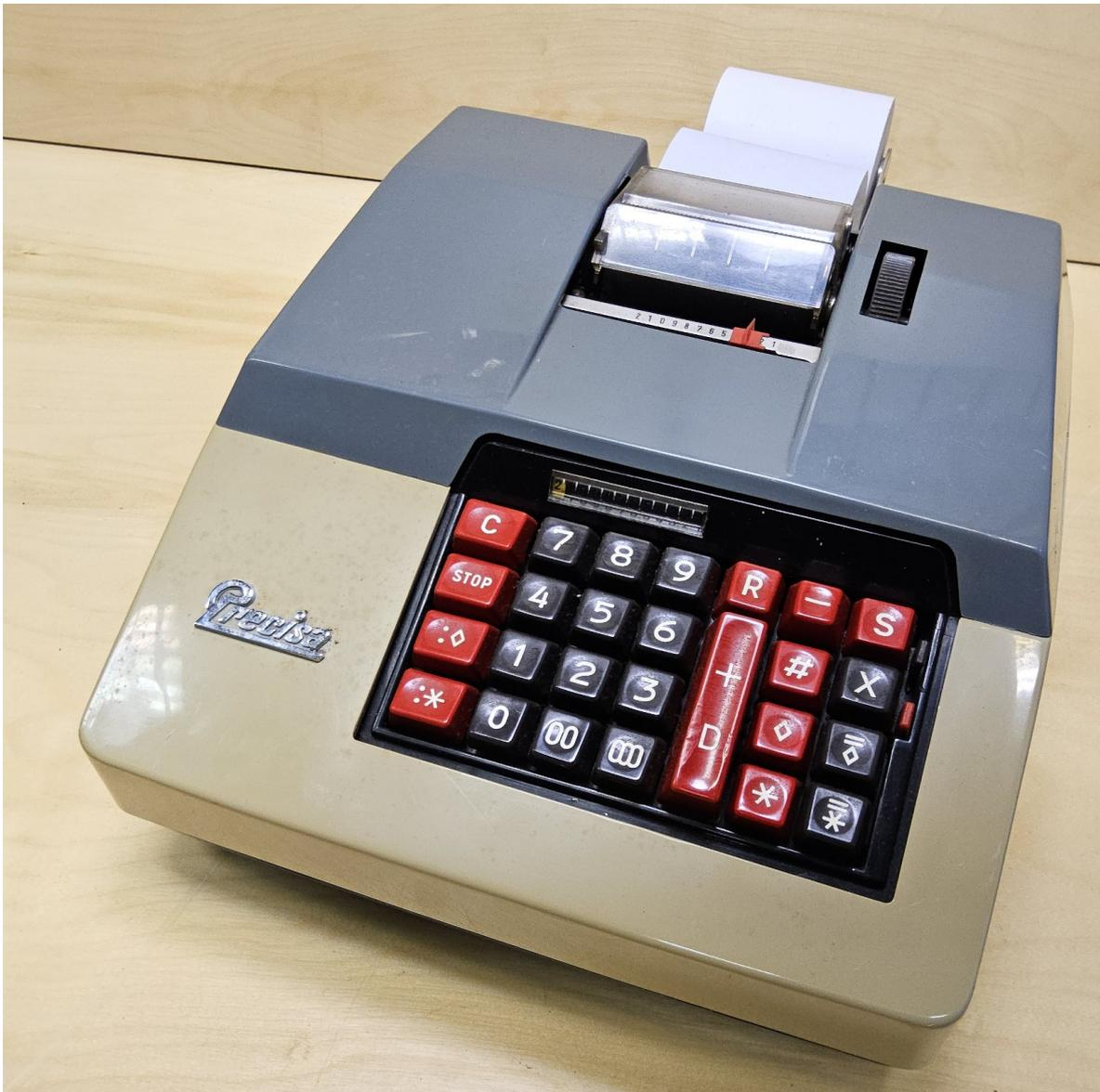
Die Precisa 166-12 ist eine elektromechanische, druckende Vierspezies-Zahnstangenmaschine mit Zehnertastatur, Stiftschlitten und Speicherwerk.
