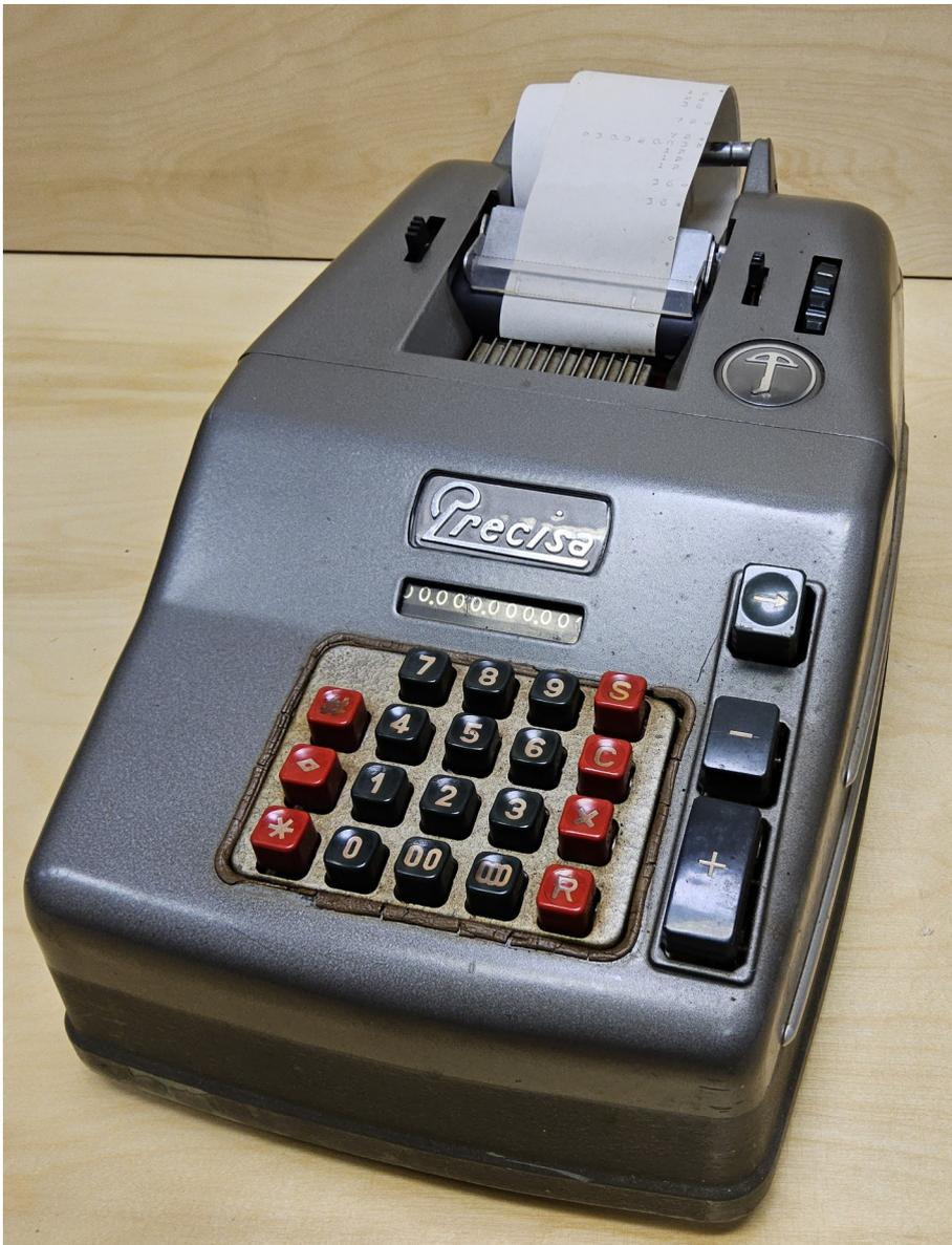
Die Precisa 110 ist eine elektromechanische, druckende Zweispezies-Zahnstangenmaschine mit Zehnertastatur und Stiftschlitten, saldierend.
