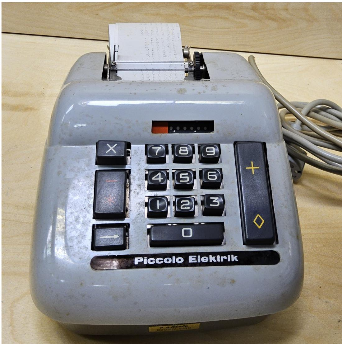
Die Piccolo Elektrik ist eine elektromechanische, druckende Zweispezies-Addiersegmentmaschine mit Zehnertastatur mit Stiftschlitten. Sie arbeitet nach dem Zahnstangenprinzip.
