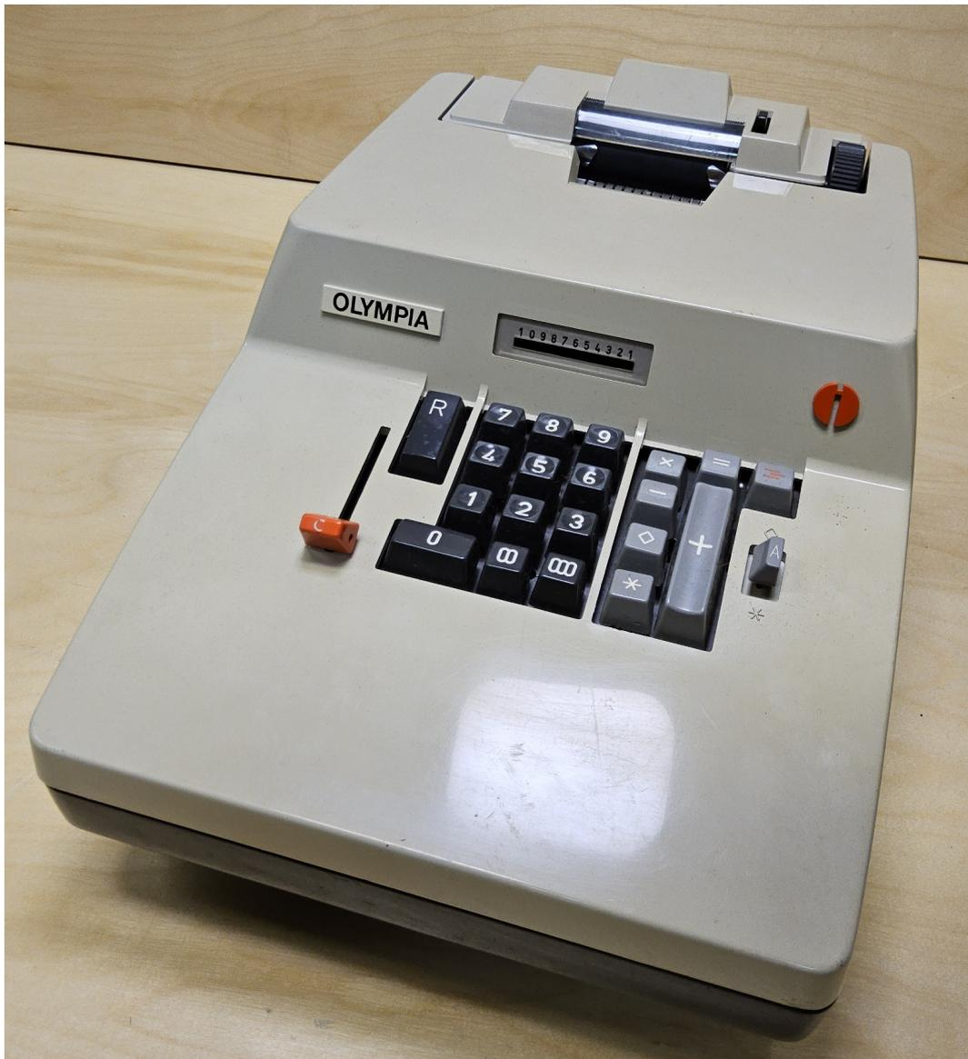
Die Olympia RAS 3/12 ist eine elektromechanische, druckende Dreispezies-Addiersegmentmaschine mit Multiplikation und Rückübertragung
