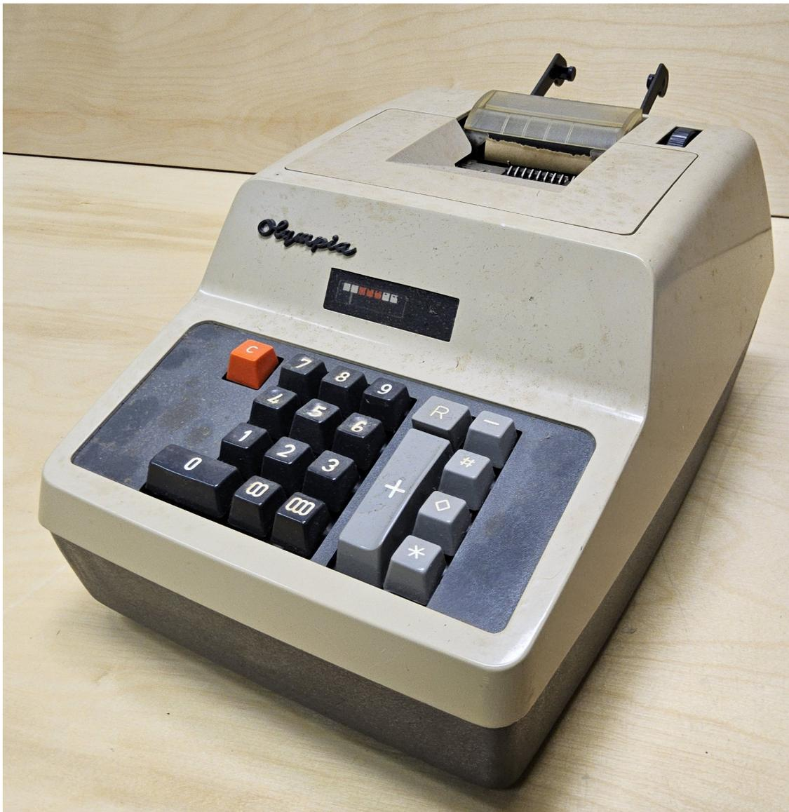
Die Olympia AE8 ist eine elektromechanische, druckende Zweispezies-Addiersegmentmaschine mit Zehnertastatur.
