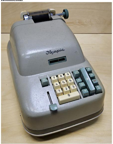
Die Olympia 441-016 ist eine elektromechanische, druckende Dreispezies-Addiersegmentmaschine mit Zehnertastatur. Sie arbeitet nach dem Zahnstangenprinzip.
