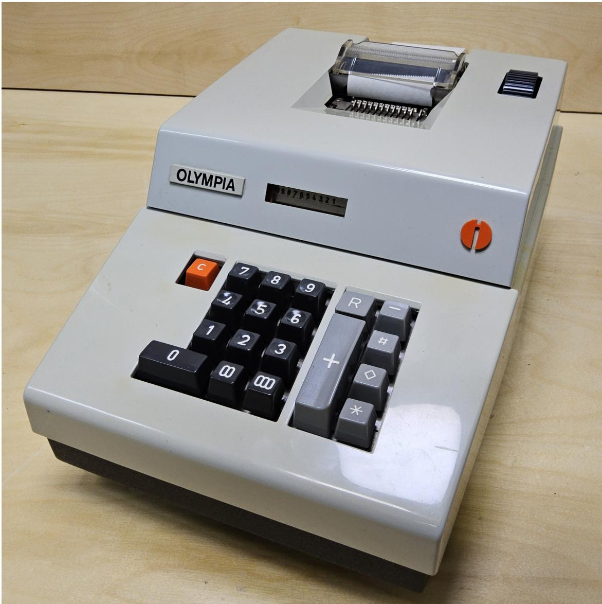
Die Olympia AE11 ist eine elektromechanische, druckende Zweispezies-Addiersegmentmaschine mit Zehnertastatur.
