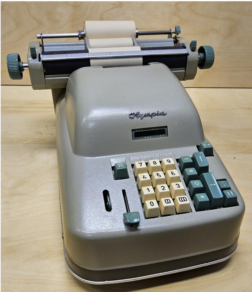
Die Olympia 132-263 ist eine elektromechanische, druckende Dreispezies-Addiersegmentmaschine mit Zehnertastatur und zwei Resultatwerken. Sie arbeitet nach dem Zahnstangenprinzip.
