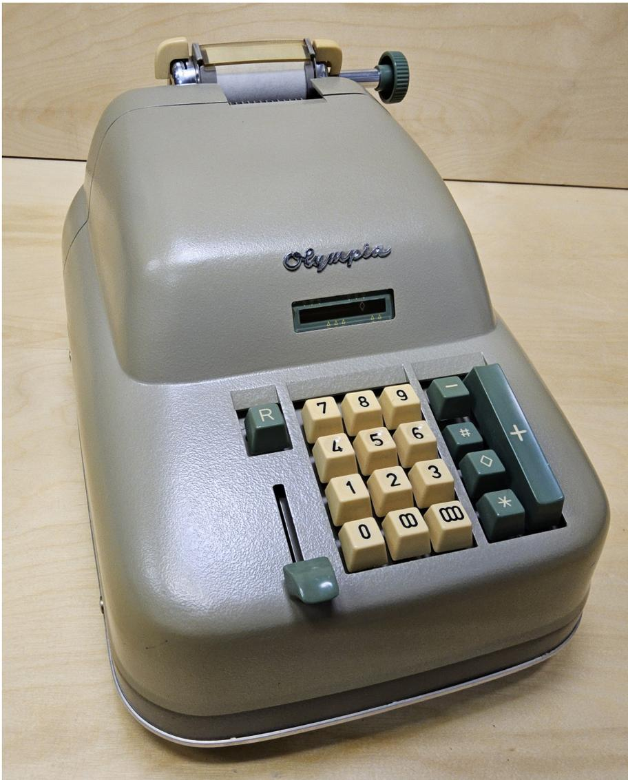
Die Olympia 132-060 ist eine elektromechanische, druckende Zweispezies-Addiersegmentmaschine mit Zehnertastatur.
