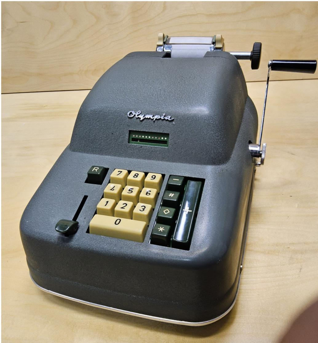
Die Olympia 122-090 ist eine elektromechanische, druckende Zweispezies-Addiersegmentmaschine mit Zehnertastatur.
