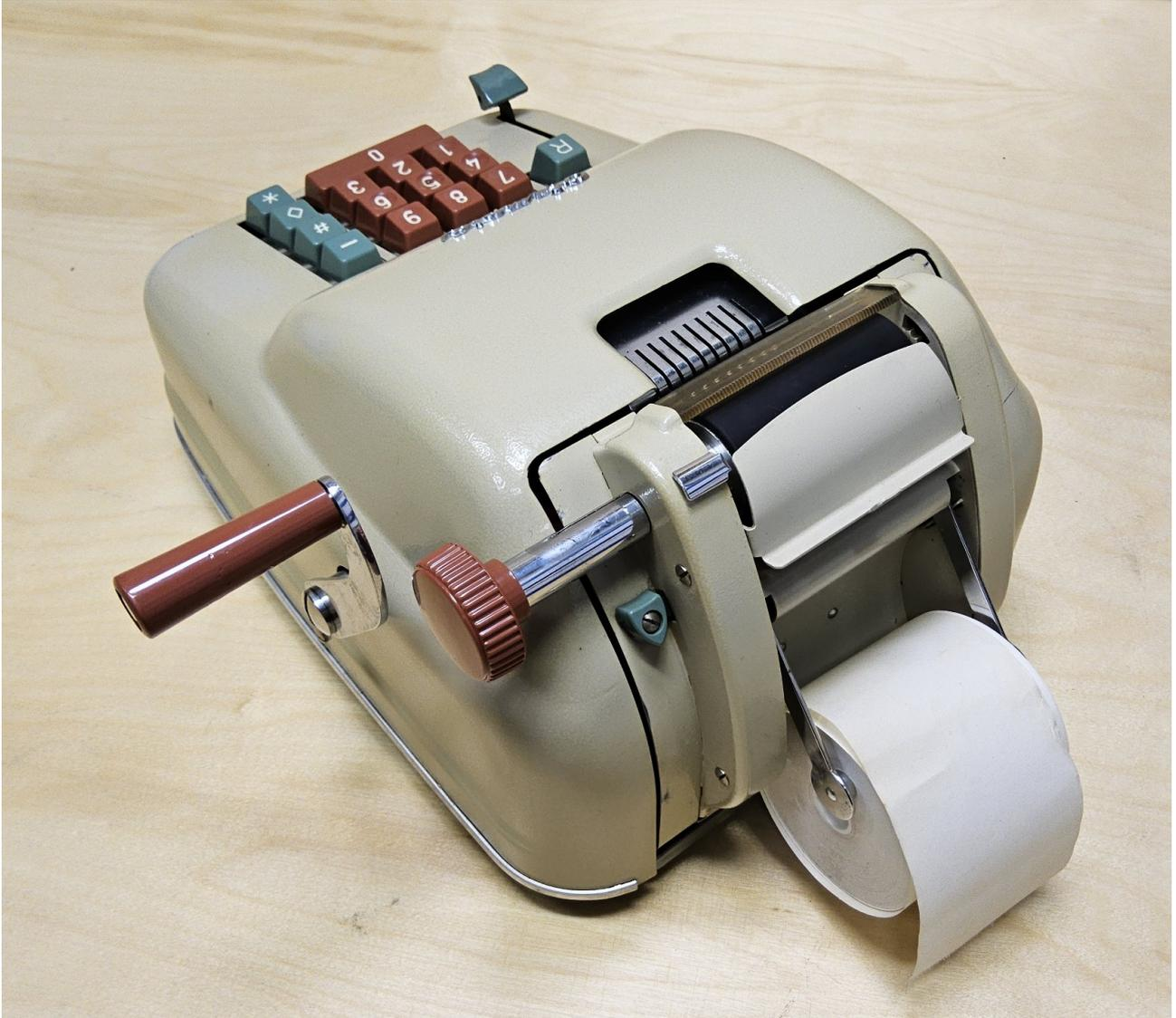
Eine Version dieses Geräts wurde von Monroe in Amerika weiterverkauft, um die Reihe der nichtdruckenden Rotationsrechner zu ergänzen. Die Monroe 811 verfügt über drei zusätzliche Antriebsräder, um den Bedienhebel näher an die Mitte der Maschine zu bringen, ist aber ansonsten identisch mit der Olympia 1182.
