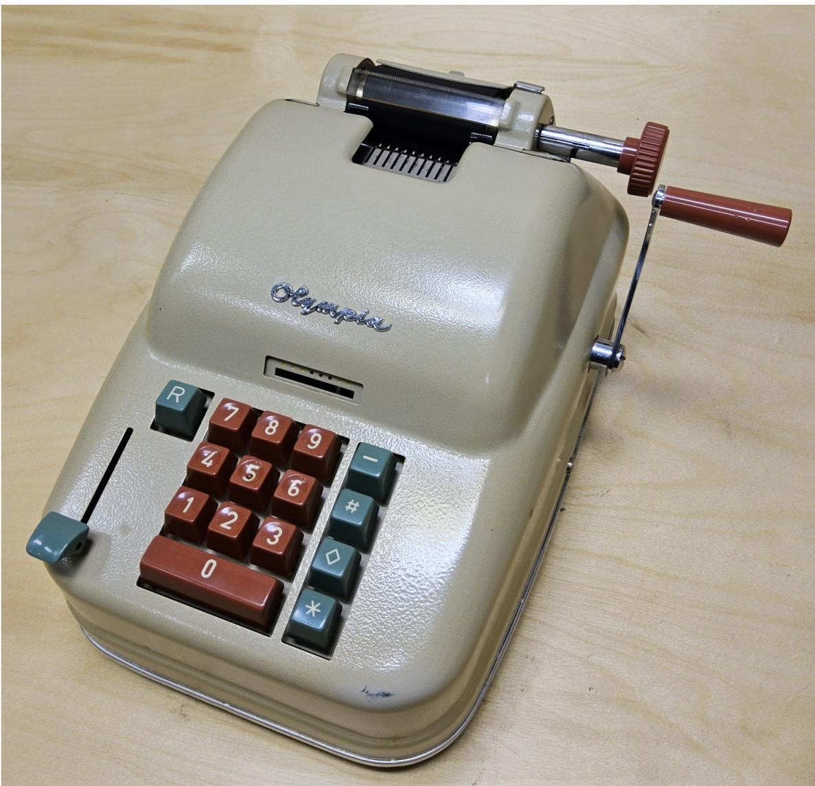
Die Olympia 1182-030 ist eine mechanische, druckende Zweispezies-Addiersegmentmaschine mit Zehnertastatur.
