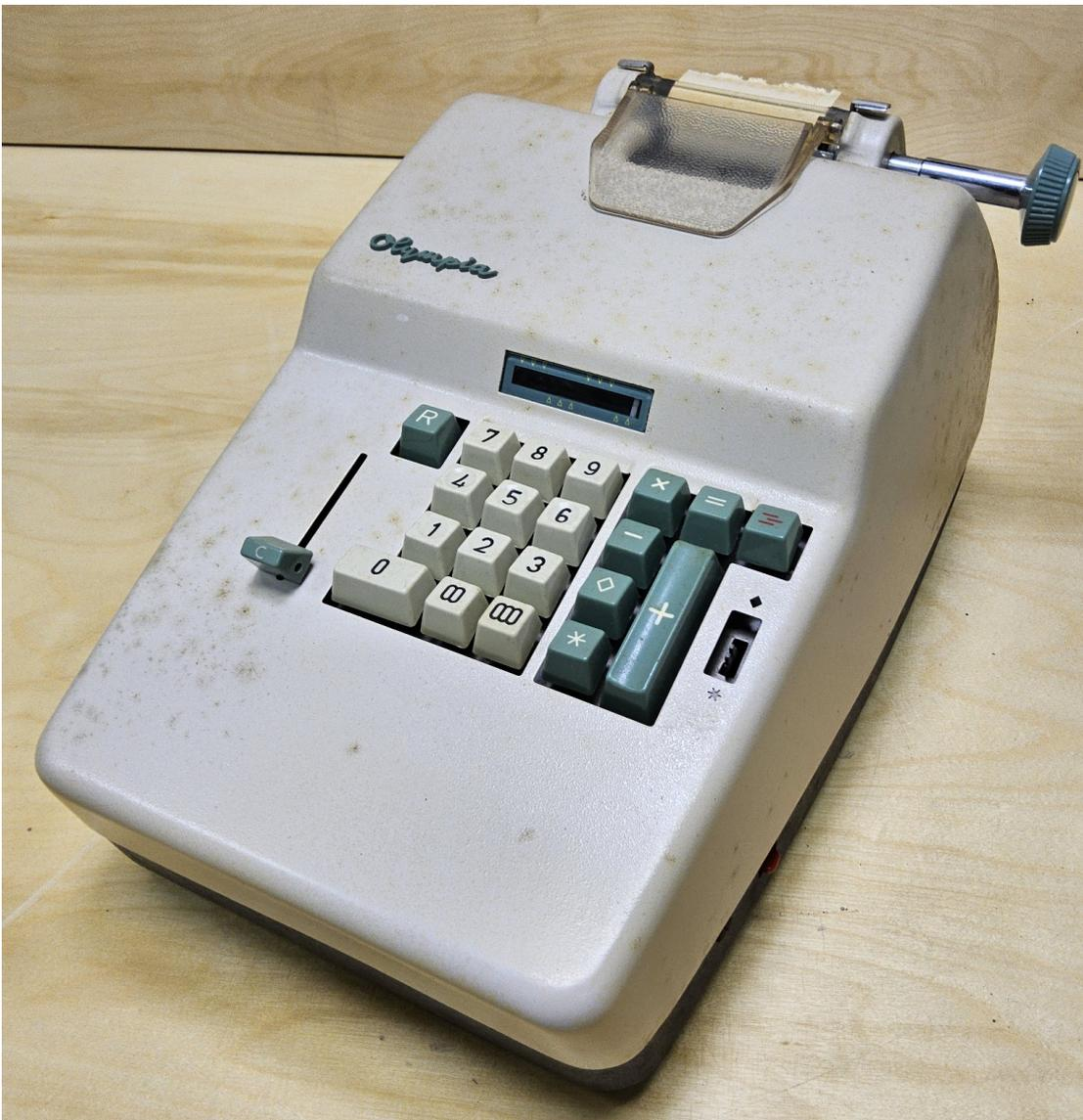
Die Olympia RAS 3/12 ist eine elektromechanische, druckende Dreispezies-Addiersegmentmaschine mit Zehnertastatur.
