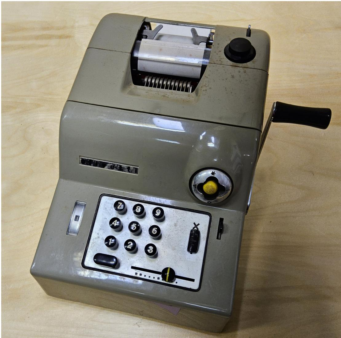
Die Olivetti Summa 15 ist eine mechanische, druckende Zweispezies-Zahnstangenmaschine. Die Eingabe erfolgt über eine Zehnertastatur. Die Maschine rechnet auch unter Null.
