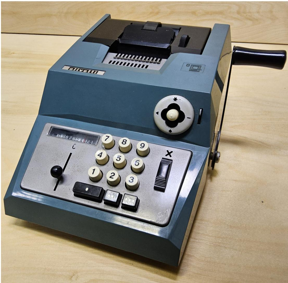
Die Olivetti Summa Prima 20 ist eine mechanische, druckende Zweispezies-Zahnstangenmaschine.
