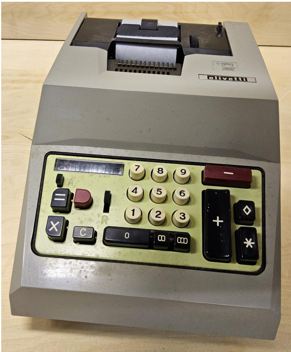
Die Olivetti Multisumma 20 ist eine elektromechanische, druckende Dreispezies-Zahnstangenmaschine.
