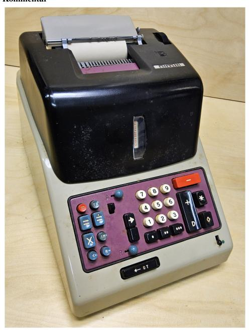
Die Divisumma 24 GT ist eine elektromechanische, druckende Vierspezies Zahnstangenrechenmaschine mit zweitem Saldierwerk.
