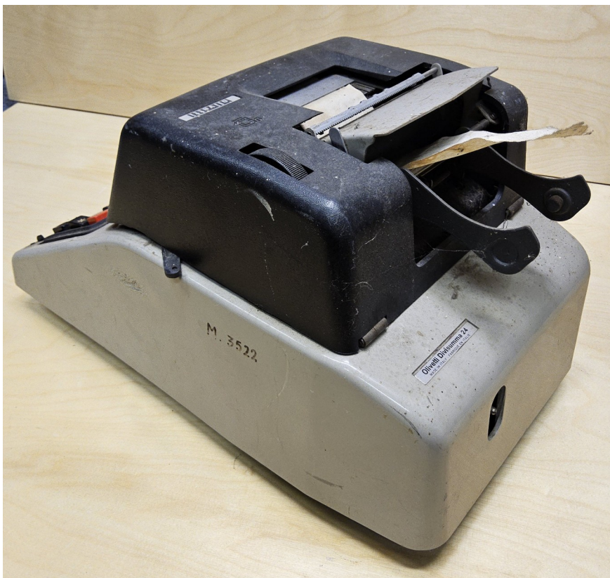
Einstellwerk: 12-stellig Rechenwerk: 13-stellig
