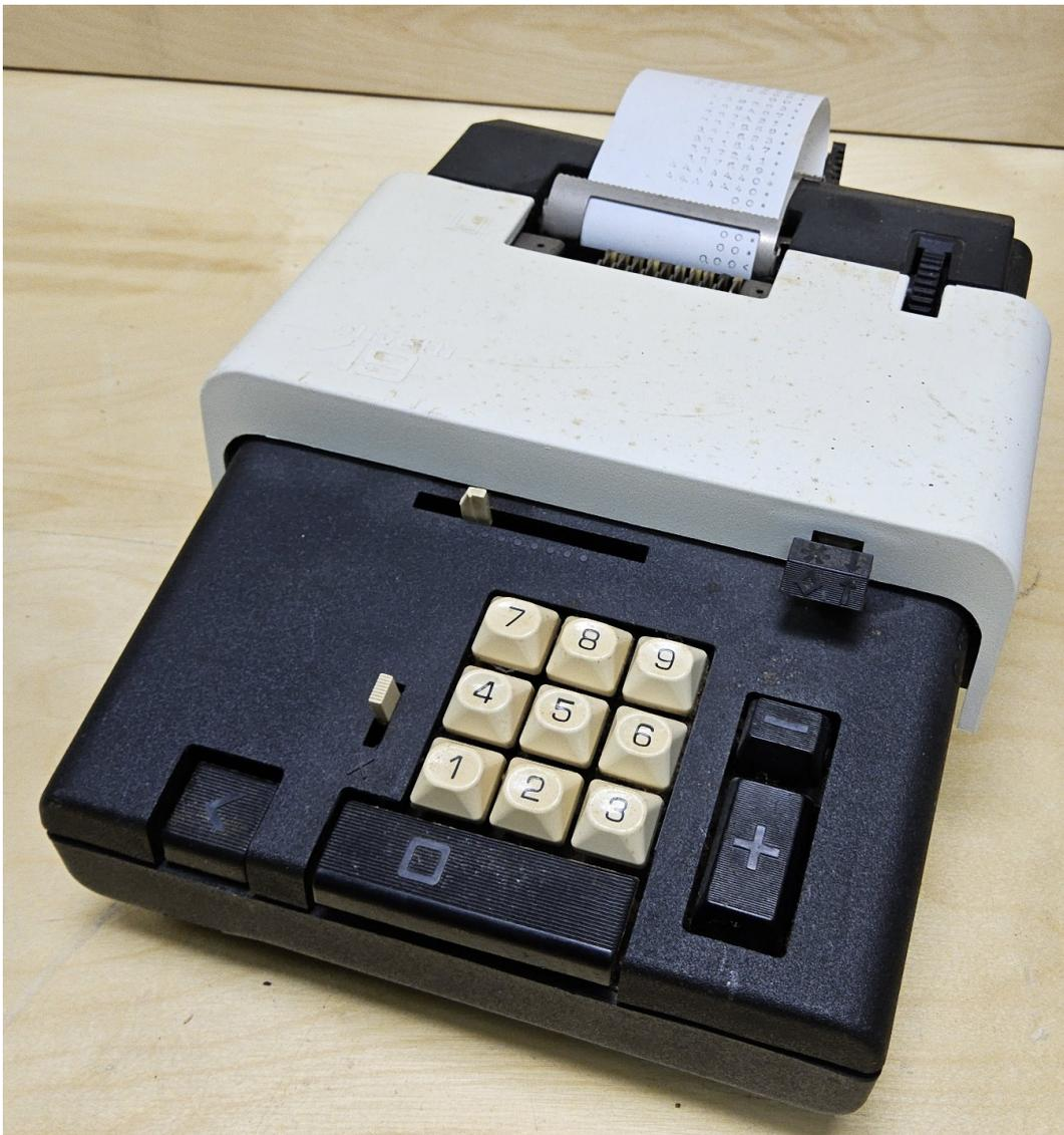
Die Olivetti Summa 19 ist eine saldierende, druckende, elektrische Addiermaschine.
