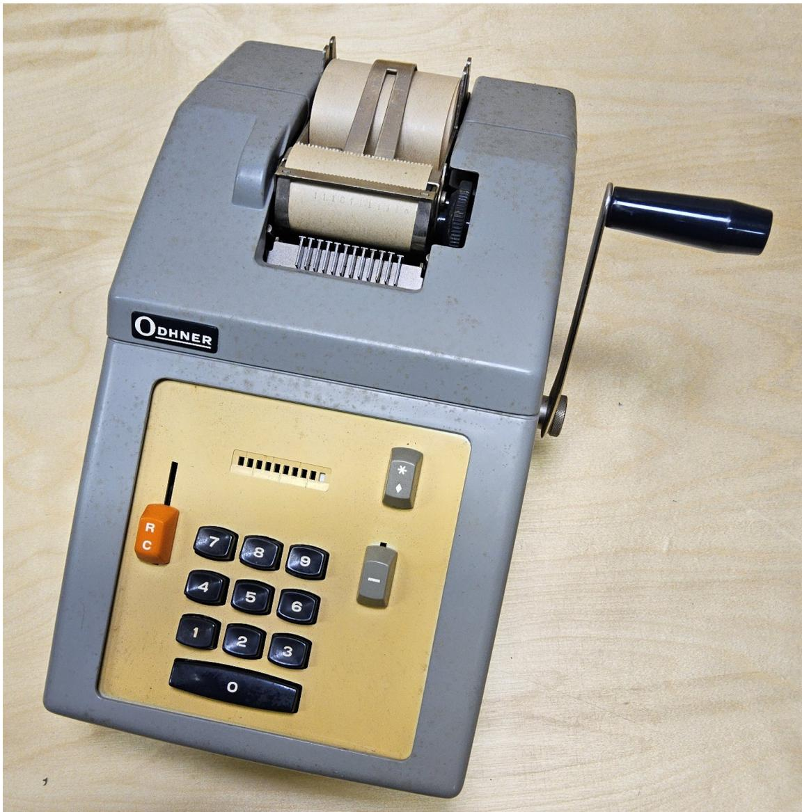
Die H11C7 ist eine manuelle, druckende Additionsmaschine.
