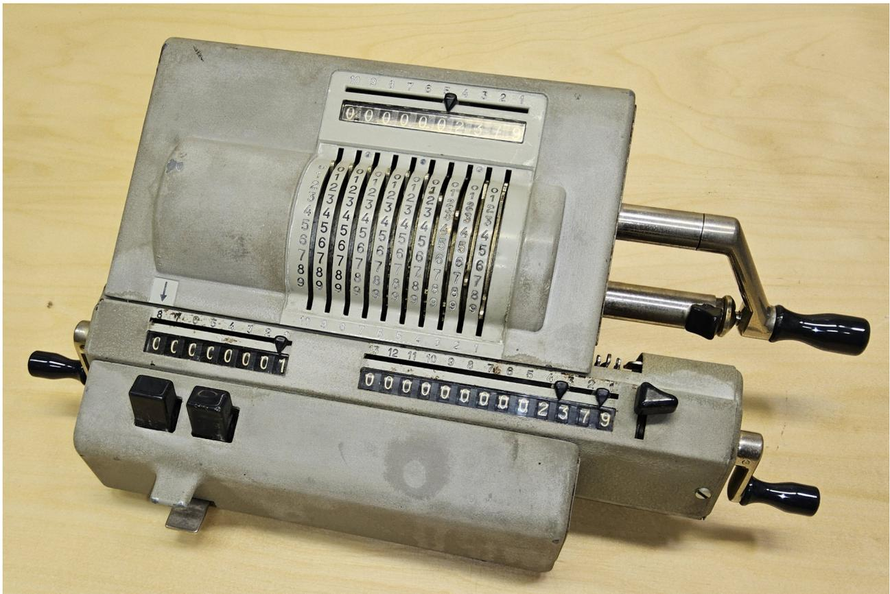
Die Odhner 239 ist eine Vierspezies-Sprossenradmaschine, mit Rückübertragung. Das Modell 239 wurde von 1955 bis 1970 gebaut.
