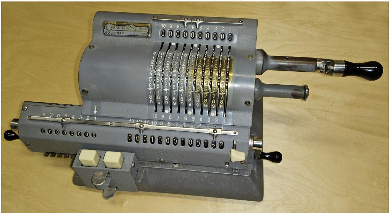
Die Odhner 137 ist eine Vierspezies-Sprossenradmaschine, mit Rückübertragung.
